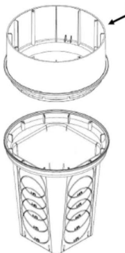
Figure 9. Caractéristiques des réhausses de la boîte de distribution et de la boîte d'échantillonnage
